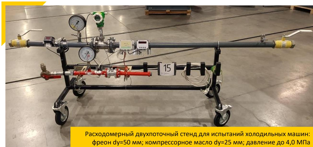
Расходомерный двухпоточный стенд для испытаний холодильных машин: фреон  $d_y=50$  мм; компрессорное масло  $d_y=25$  мм; давление до 4,0 МПа
